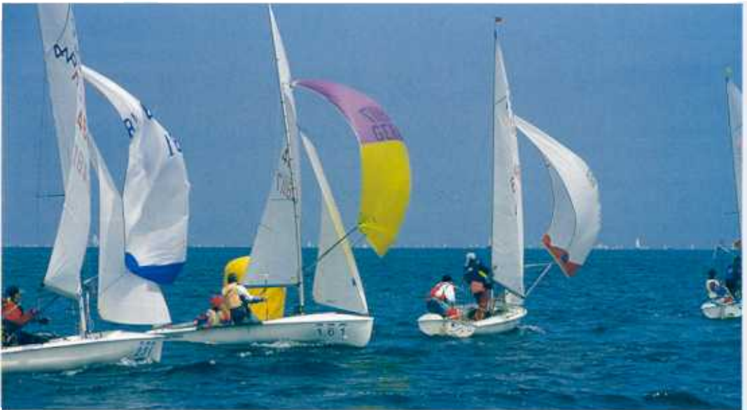
Hier fällt der Wind mehr von der Seite ein, und die Spinnakerbäume stehen schon am Vorstag an. Da stellt sich bald die Frage, ob es nicht besser ist, das Ballonsegel zu bergen.
